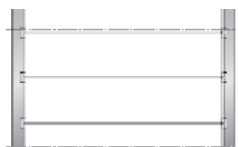
Maestral®和Maestral® Slim: 立柱+短槽式挂装系统
