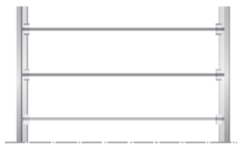
Piterak® XS和Piterak® Slim: 立柱+短槽式挂装系统
