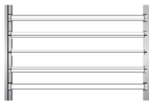
Autan® XL, Harmattan® XL, Zonda® XL, Shamal®: 单个产品+ 防破损和坠落的安全装置, 直接固定在两端的支撑件上
