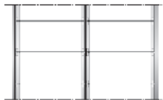
Blizzard®: 立柱+纵向橡胶止水条+短槽式挂装系统
